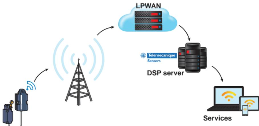
Le transmetteur autonome **XIOT11SE●●●** permet d'exploiter les changements d'état d'un ou deux contacts secs par liaison radio de type **LPWAN**. Les informations transmises sont mises à disposition sur le web via un navigateur internet ou à partir d'applications mobiles IOS et Android. Les données sont également accessibles par des applications propriétaires pour des traitements spécifiques.
