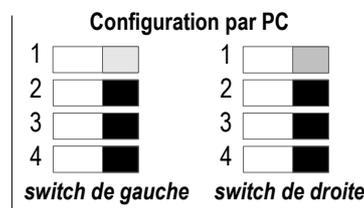
**Attention : La configuration des paramètres s'effectue soit par switch soit par logiciel. Les deux ne sont pas compatibles.**
