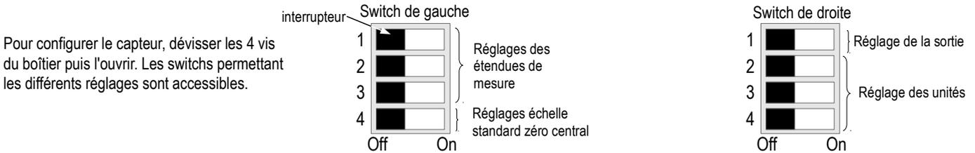
Pour configurer le capteur, dévisser les 4 vis du boîtier puis l'ouvrir. Les switches permettant les différents réglages sont accessibles.
