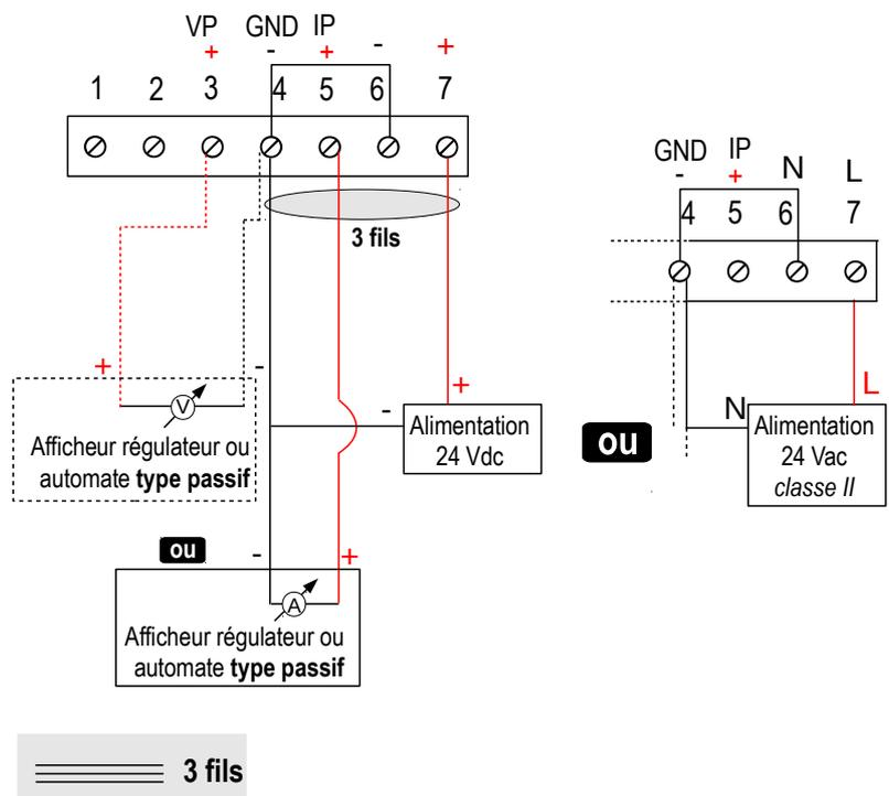
Pour les modèles **CP114/115 – PO** et **CP114/115 – PN** avec sortie 0-10 V ou 4-20 mA – **passif** :
