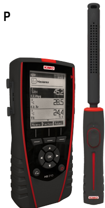
HQ210 + SCOH 112 Sonde (Temperatur- / Feuchte- / CO 2 -Sonde)
