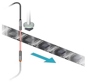
**Wafer inclination detection**
